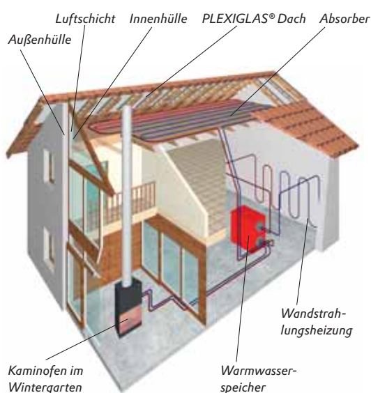
Haus im Haus: Innen- und Außenhülle, die Luftschicht dazwischen sowie weitere Elemente machen das Bio-Solar-Haus zu einer energiesparenden und gesunden Wohnform.
