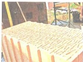
„Unipor W07 Coriso“-Planziegel heißt der Stein, dessen Dämmstoff-Füllung aus natürlichem Mineralgranulat besteht. In Dresden wurde dieses Haus mit einem einschaligen Mauerwerk aus Planziegel ausgeführt, das den Passivhaus-Standard unterbietet. Durch die bauaufsichtliche Zulassung ist der Stein nun auch rechtlich abgesichert. [www.leipfinger-bader.de](http://www.leipfinger-bader.de)
